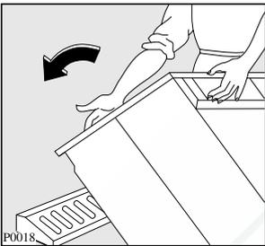
2. Наклоните машину на заднюю панель и проложите между ней и полом полиэтиленовый уголок.
