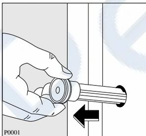
4. Установите машину в вертикальное положение и удалите три пластмассовых болта.
