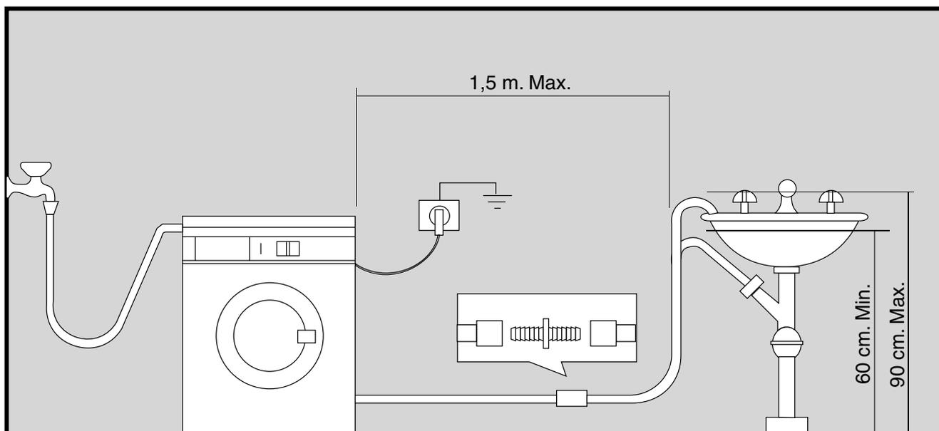
**ВАЖНО:** Расстояние от пола до верхней части шланга должно составлять от 60 до 90 см (Рекомендуется расстояние от 60 до 70 см). Шланг не должен сжиматься или перекручиваться, чтобы не затруднять прохождение воды. При необходимости использования удлинителя сливного шланга его длина ни в коем случае не должна превышать 1,5 м, а удлинитель должен быть того же диаметра, что и шланг стиральной машины. Убедитесь, что шланги не натянуты.
