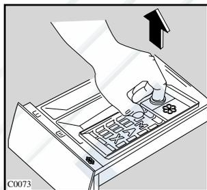
Моющее средство может также скопиться и в отсеке для дозатора. Очистите его старой зубной щеткой. После очистки установите дозатор на место.
