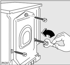
1. Отверните ключом и удалите три винта с задней панели машины.
